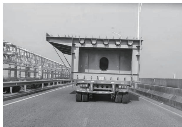
图 6 钢箱梁运输及固定措施
